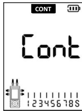
Złącze RJ45 prawidłowe
