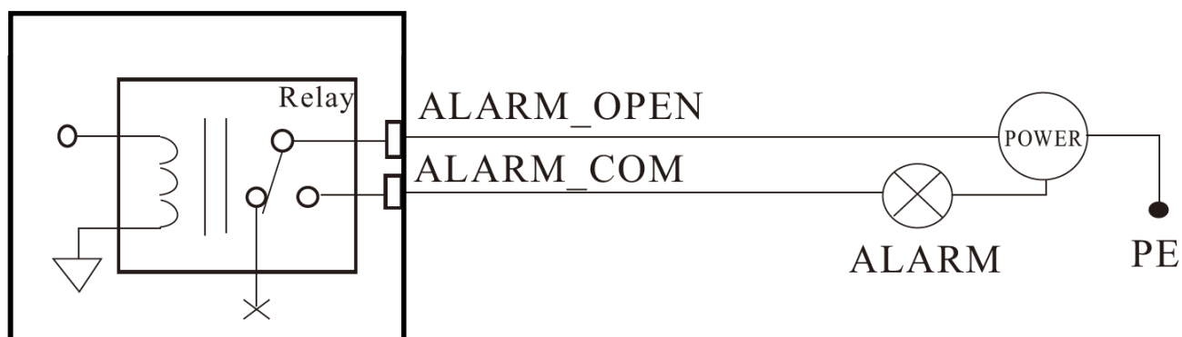
Typowe połączenia wyjścia alarmowego Maks. 30VDC/1A
